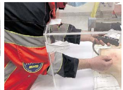
Ein Prototyp der „Intubox“ während der Testphase mit einer Puppe
